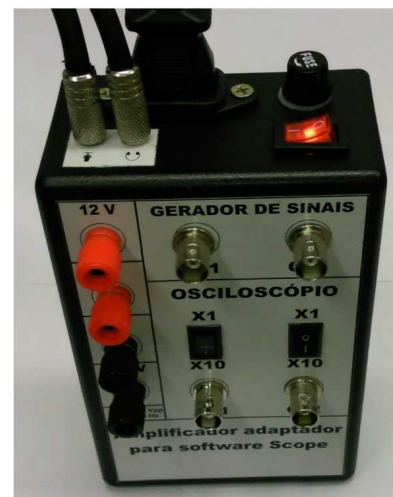
Figura 3: Visão externa do adaptador de tensão para uso do software SCOPE® como osciloscópio.
