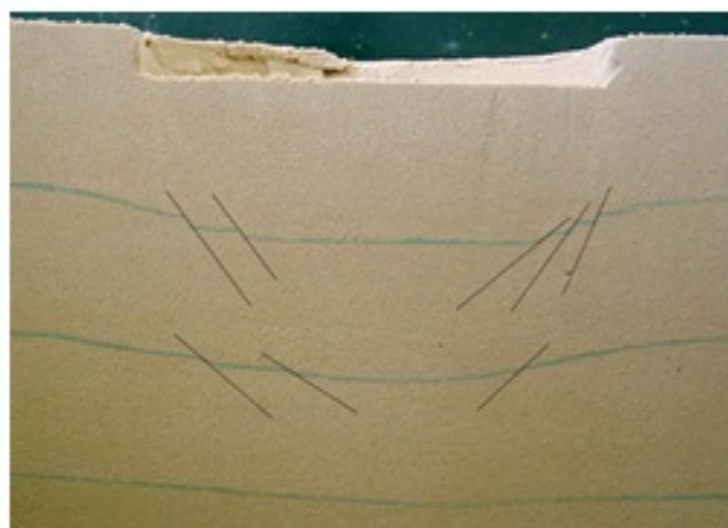
Figura 4: formação da cunha no ensaio em areia
