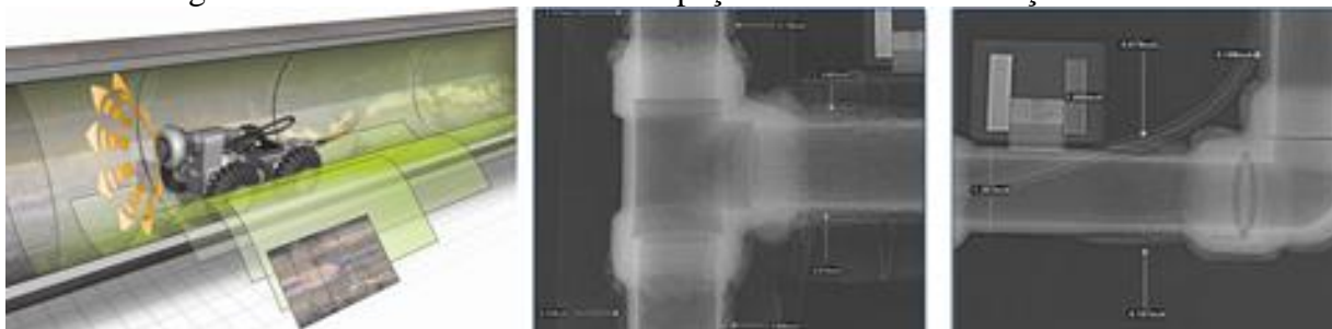
Figura 1 - Câmera Robotizada de Inspeção e raio-x em tubulações.
