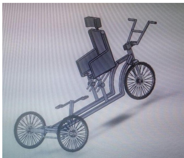
Figura 1 - Desenho 3D do Triciclo Adaptado
