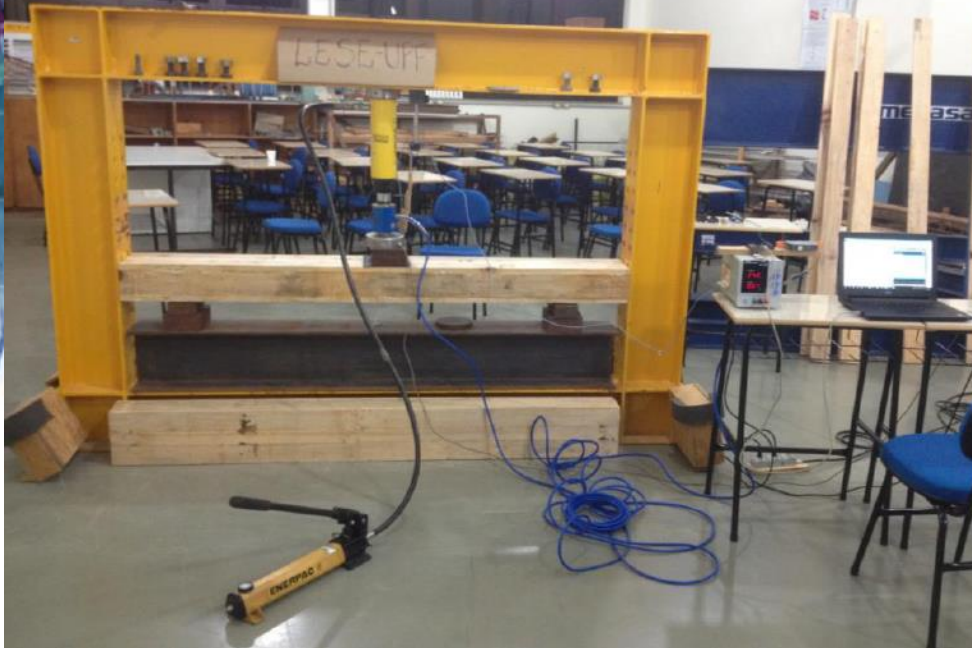
Figura 1 – Ambiente de ensaio e dormente confeccionado. (Pozzer, 2016)
