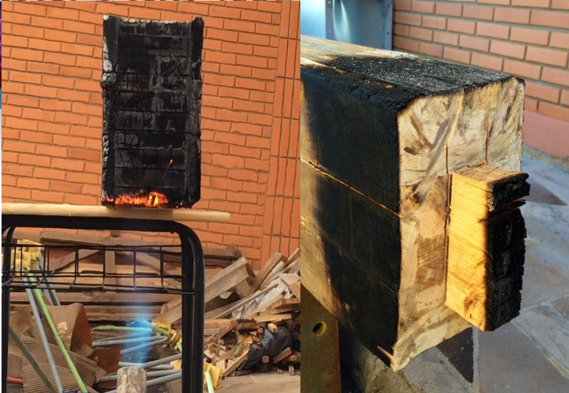
Figura 1 – Peça estrutural anterior e pós queima
