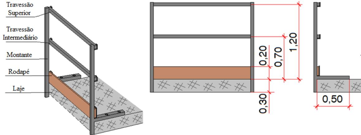
Desenvolvimento de cálculos para o dimensionamento da estrutura do guarda-corpo metálico.
