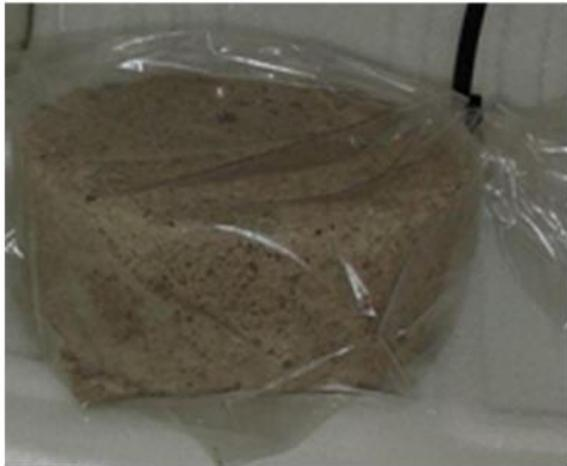
**Figura 2:** Corpo de prova submetido ao ciclo de gelo
