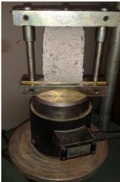
**Figura 3:** Rompimento a compressão diametral
