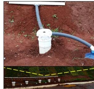
Figura 6: Sistema coletor das amostras acoplado ao divisor Geib adaptado.
