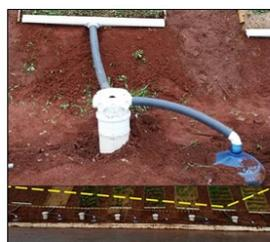
Figura 2: Sistema de coleta das amostras com divisor Geib.
