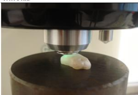
Figura 4 - Amostra posicionada no Microdurômetro.
